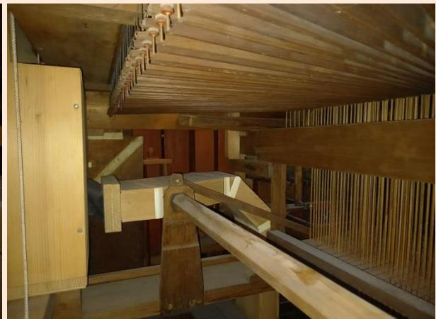
De toets- en registertraktuur werd op ambachtelijke wijze vervaardigd met houten walsen en raamwerken, abstracten en draadwerk. De moeren zijn van leer. Tussen het hout en leer is cloth aangebracht, invoeringen zijn deels van kernlaken voorzien.
